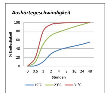
Das Diagramm zeigt den typischen Aufbau der Festigkeit bei der Verklebung von Probestücken. Wird die Temperatur um 8°C erhöht, halbiert sich die Aushärtezeit. Niedrigere Temperaturen haben eine langsamere Aushärtung zur Folge.
