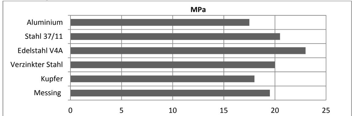
**Typische Mittelwerte der Zugscherfestigkeit verschiedener Kunststoffverklebungen (ISO 4587)**
