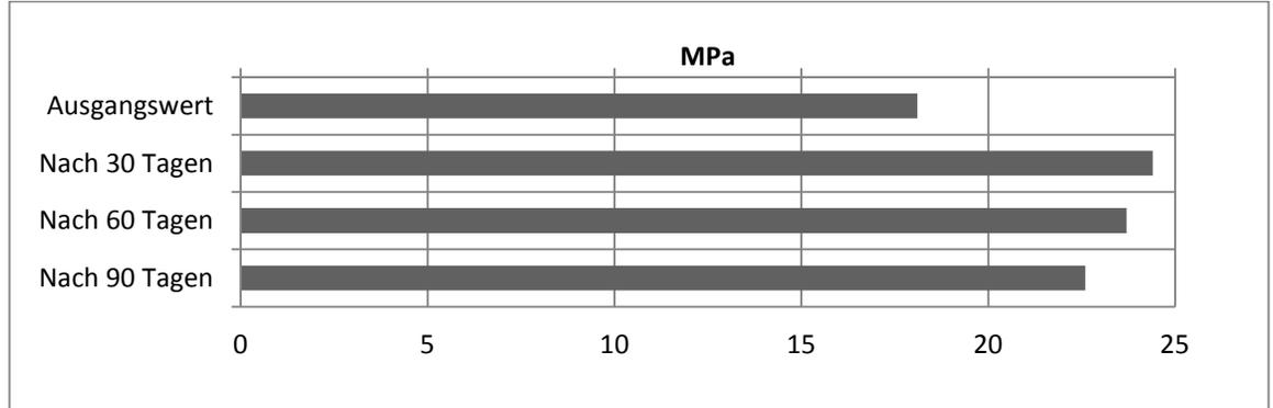
**Zugscherfestigkeit nach Wärmealterung (typische Mittelwerte)**
