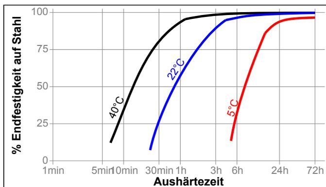
**Aushärtegeschwindigkeit in Abhängigkeit vom Aktivator**
